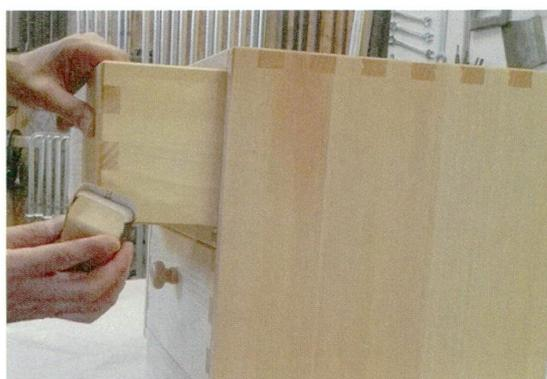
Le tavole grezze vengono lavorate nel nostro laboratorio da mani esperte, in tutte le fasi delle lavorazioni fatte con l'artigianalità che ci distingue da sempre. I vari assemblaggi ad incastro ci permettono di eliminare l'uso di colle.
